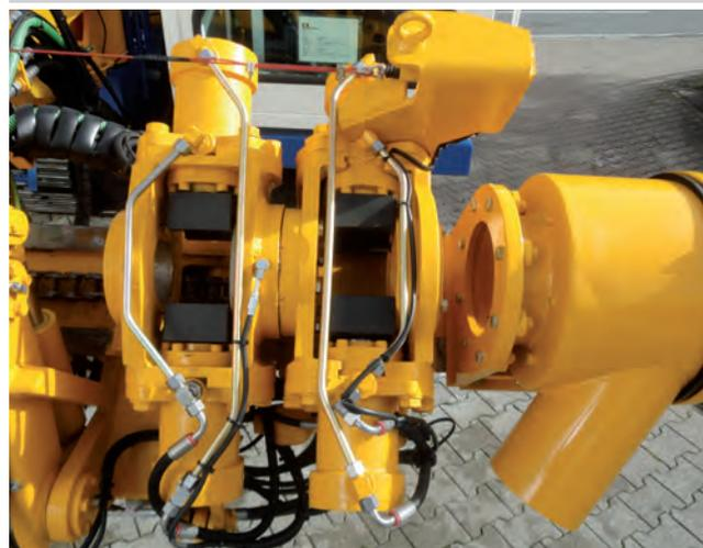
Устройство для раскручивания буровых штанг
