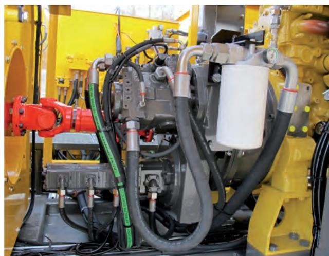
Насосный блок / pump unit
