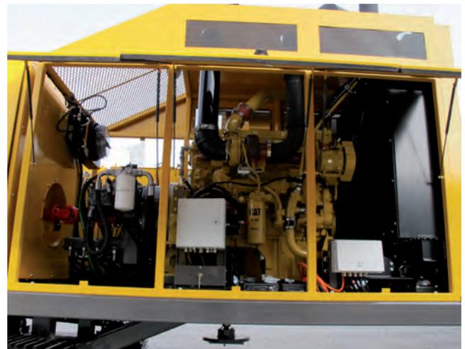
Приводной агрегат / engine compartment
