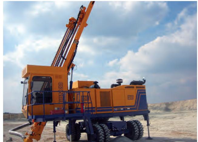
HBM 80 колесное шасси / wheeled chassis
